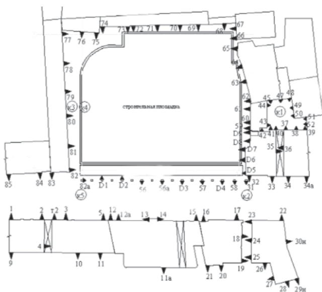
Рис. 3. Схема размещения наблюдательных марок (вертикальные перемещения)
