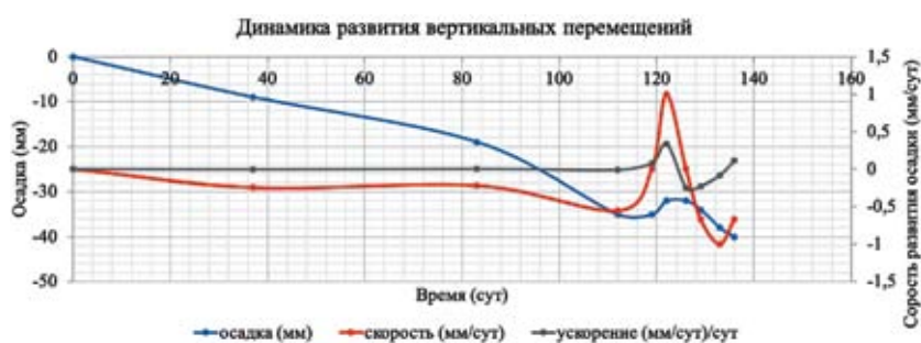
Рис. 3. Мониторинг динамики вертикальных перемещений характерной точки здания в период производства работ
