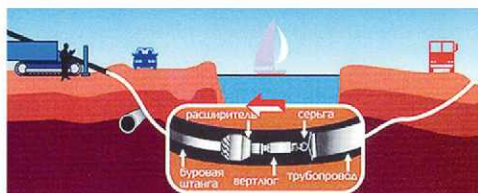
Протягивание трубопровода
